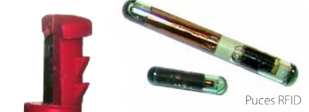
Fixation plastique intégrant une puce RFID
